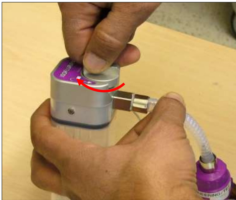
Рисунок 37. Поверніть ручку за годинниковою стрілкою для фіксації
