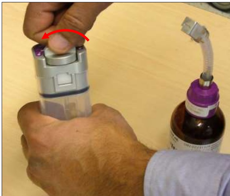
Illustration 35 : Tournez le bouton dans le sens antihoraire pour le relâcher
