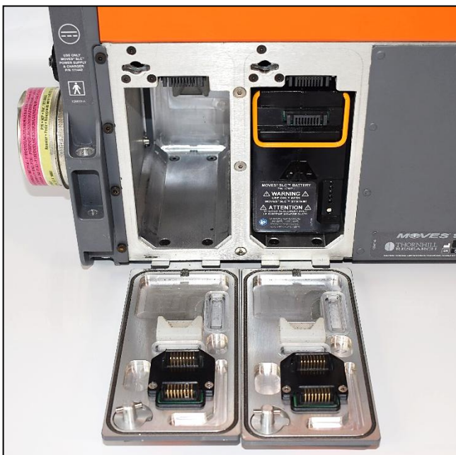
Rysunek 9-11: Akumulator odłączony (komora otwarta)
