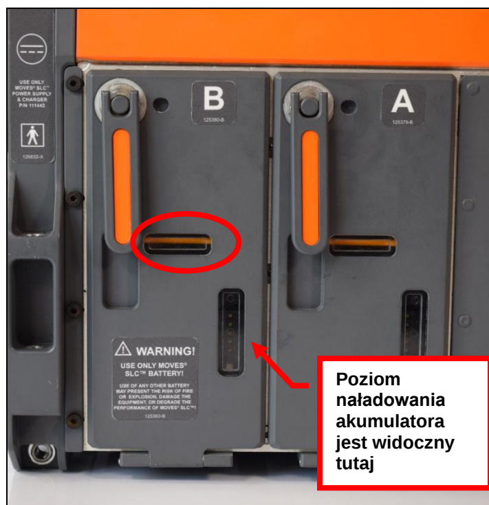
Rysunek 9-10: Widoczny żółty uchwyt oznacza obecność akumulatora
