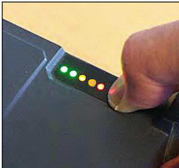
Рисунок 9-10. Індикатор стану з відображенням високого рівня заряду
