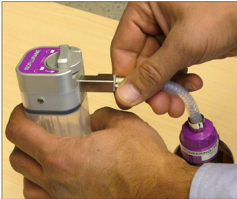
Illustration 37 : Insérez le raccord rectangulaire
