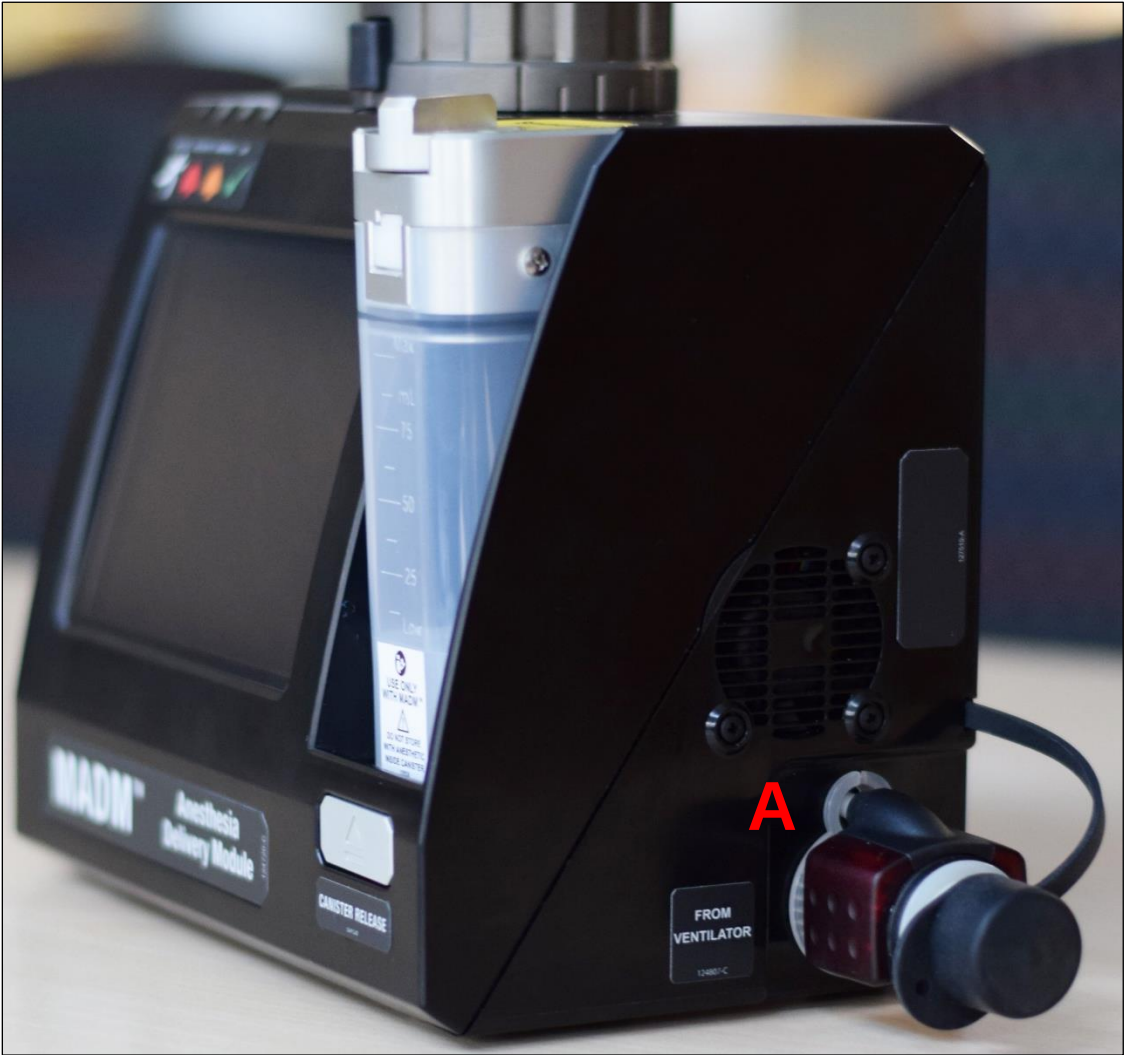
Illustration 17 : Connexions sur le côté droit
