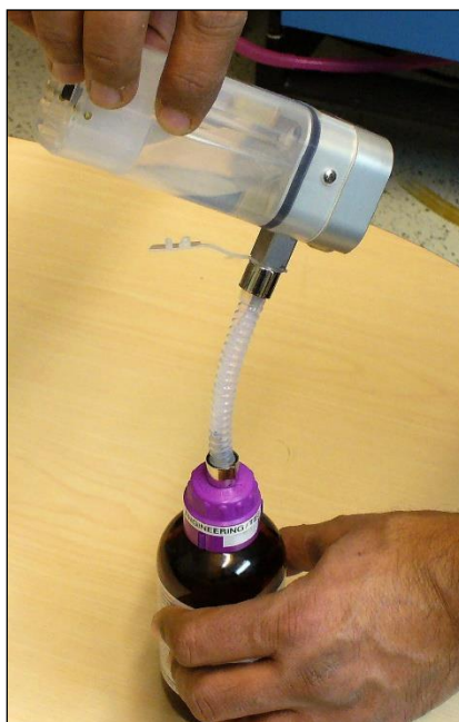
Illustration 39 : Soulevez le réservoir au-dessus du flacon
