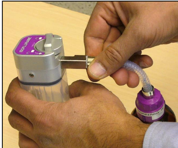
Illustration 33 : Col de cygne monté sur le réservoir
