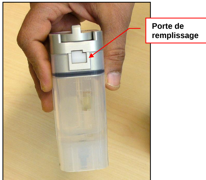
Illustration 29 : Porte de remplissage
