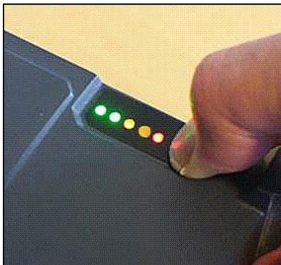
Illustration 9-10 : Témoin lumineux vert indiquant une charge de haut niveau
