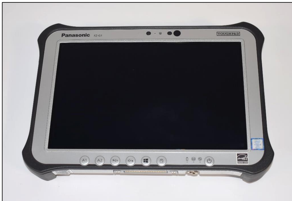
Illustration 12-1 : écran distant pour l'appareil MOVES® SLC™
