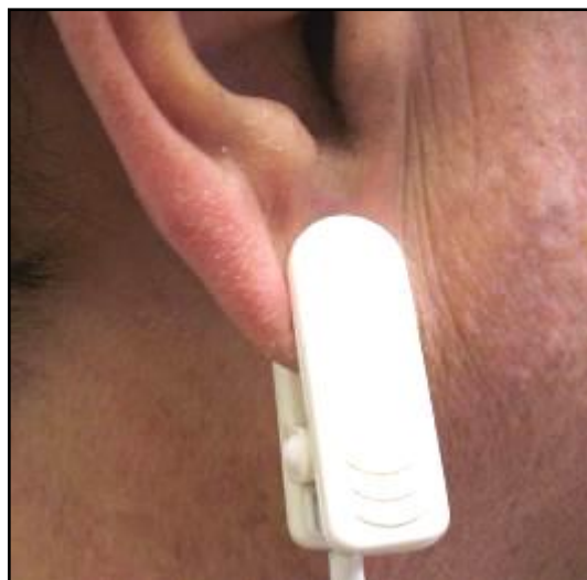
Illustration 13-2 : Placement correct du capteur de lobe d'oreille
