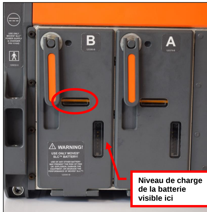
Illustration 9-11 : Poignée jaune visible indiquant la présence de la batterie
