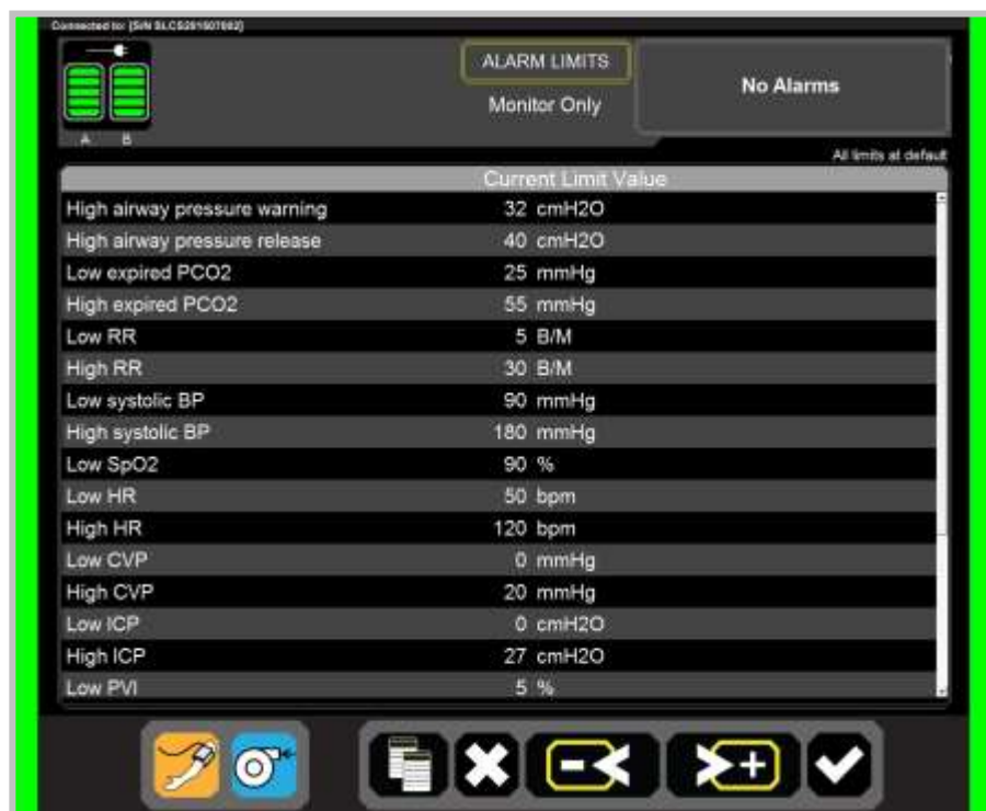
Illustration 12-12 : Les barres vertes indiquent qu'aucune alarme n'est déclenchée
