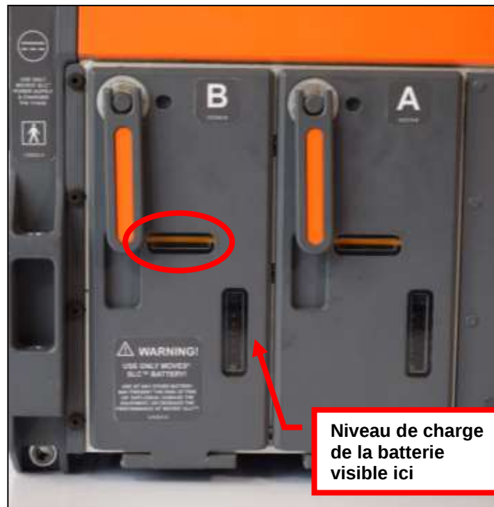
Illustration 9-11 : Poignée jaune visible indiquant la présence de la batterie
