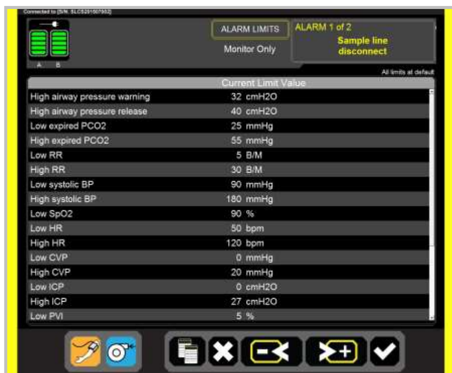
Illustration 12-14 : Les barres jaunes indiquent qu'une alarme de priorité faible ou moyenne est déclenchée
