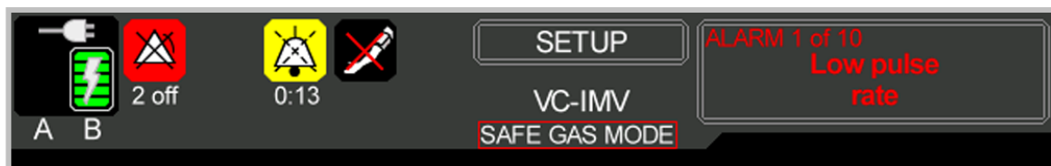
Illustration 15-8 : Barre d'état indiquant que le système est en mode Safe Gas (Gaz sécuritaire)
