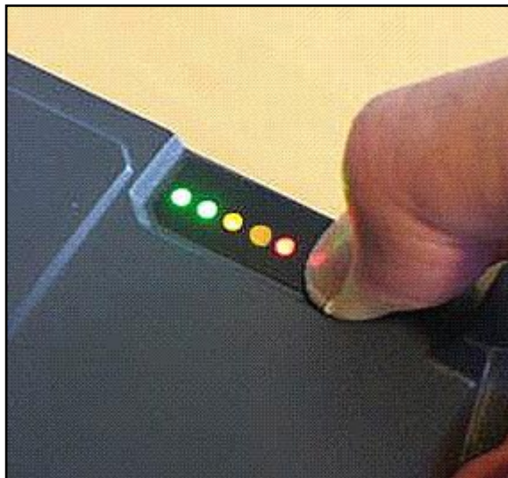
Illustration 9-9 : Témoin lumineux vert indiquant une charge de haut niveau
